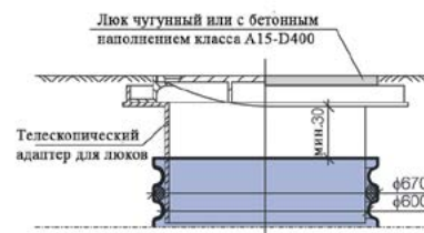
Люк А15, В125 или D400 на телескопическом адаптере
